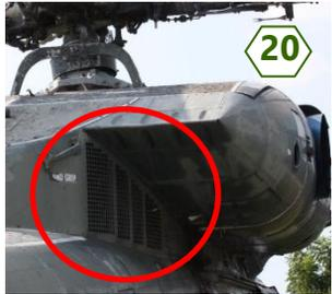
les aérations mais, comme toujours en pareil cas, on est confronté au problème d'affleurement : collée à l'extérieur, la grille crée une surépaisseur et, collée à l'intérieur, c'est l'épaisseur de la paroi qui saute aux yeux. Après plusieurs tâtonnements successifs et infructueux, j'ai
