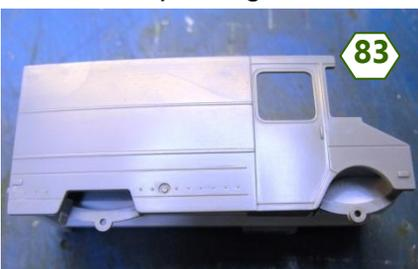
aussi un élément qui fait défaut : les passages de roues laissent le regard découvrir un vide criant et de la carte plastique est utilisée pour créer des écrans qui vont remédier à cette situation (Photo 83). A ce stade, j'ai préparé les flancs du véhicule en éliminant par ponçage les petites protubérances sensées représenter les clignotants : plutôt que de les peindre
