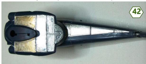
La position asymétrique des plaques sur la poutre peut surprendre mais elle correspond à la réalité : sur cet appareil, le tunnel de l'arbre de transmission part de la gauche du groupe moto-propulseur.
