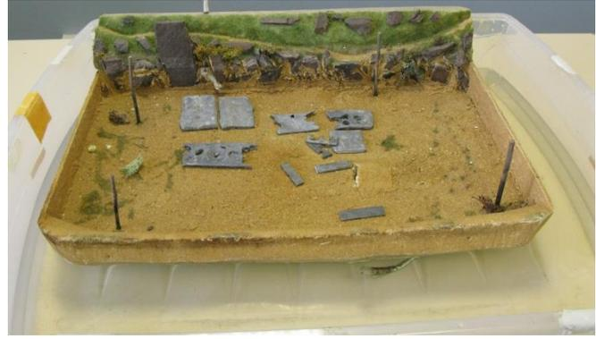
... Puis un plateau flottant (styrodur) décoré y est placé. Quelques poids en plomb assurent le niveau de flottaison souhaité.
