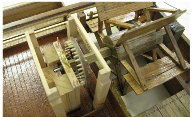
Le mécanisme à l'intérieur : la roue à aubes entraine une roue crantée qui va assurer la rotation de la meule qui viendra au dessus.
