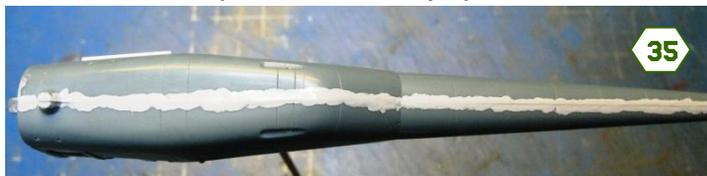
Après un premier ponçage aux abrasifs de plus en plus fins, une nouvelle application de mastic est réalisée là où nécessaire
