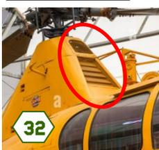
A l'avant du château supportant le rotor se trouve l'ensemble d'entrées d'air (0 Photo 32) que le fabricant de la maquette représente par une pièce assez grossière, surdimensionnée dans la largeur et sous-dimensionnée en épaisseur ainsi que par une grille en photo découpe. Je n'ai gardé que cette dernière pour la coller sur une nouvelle pièce fabriquée à
