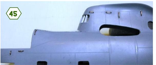
représentées et elles sont faites en fil de cuivre formé à froid puis collées à la cyano dans les trous forés antérieurement. Elles sont ensuite recouvertes au pinceau d'apprêt métal, comme toutes les autres parties métalliques (gouttière, charnières ...). La cellule passe alors à la pâte à polir puis est nettoyée au liquide vaisselle et rincée.
