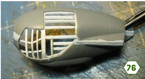
Encouragé par ce résultat, j'ai alors conçu l'idée de réaliser l'ensemble des surfaces grillagées de la même façon : des lamelles sont collées sur le pourtour de l'ouverture et, en m'aidant des photos de l'appareil réel, d'autres viennent figurer les montants transversaux (photo 76). Cette ossature est alors complétée, là où nécessaire, par des sections de profilé de 0,5 mm permettant d'affleurer la surface, puis de la
