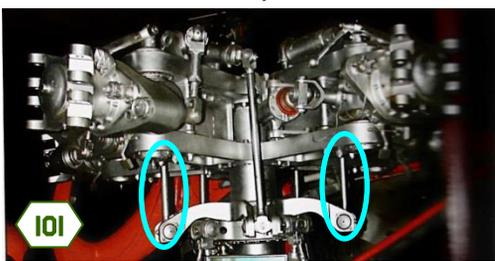
résine sont fournies, sans photo découpe. L'ensemble est globalement conforme à la réalité mais il manque les biellettes verticales (O photo 101), pour lesquelles j'ai fait appel à des sections de tige métal Ø 0,4 mm . J'ai également représenté quelques durits à l'aide de fil
