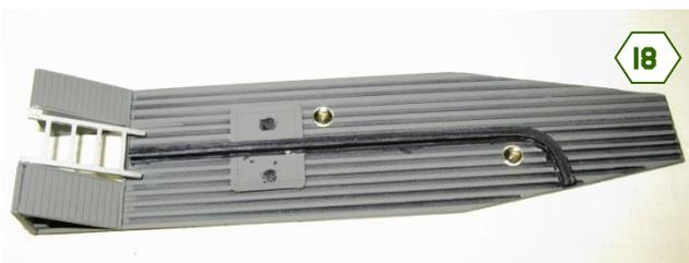
complété par des lentilles représentant les plafonniers, une échelle, et un profilé gravé qui figure le monorail permettant la circulation du treuil et la manipulation des charges (Photo 17).
