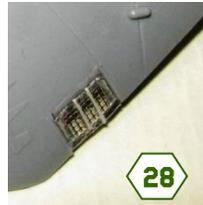
Une autre grille à l'arrière (sur le seul côté bâbord de la jonction avec la poutre) et celle située en bas de l'extrémité de la queue sont traitées de la même façon (Photos 27 & 28).
