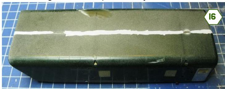
En revanche, les dommages sont tels sur la partie supérieure (Photo 16), que la seule solution envisageable consiste à doubler le toit à l'aide d'une plaque de carte plastique de 0,25 mm sur laquelle les lignes de structure sont gravées une à une. Là encore, j'ai ajouté à un endroit une largeur d'aluminium adhésif et une trappe (carte plastique) qui sont marquées par la roulette à riveter et qui recevront ultérieurement des antennes.
